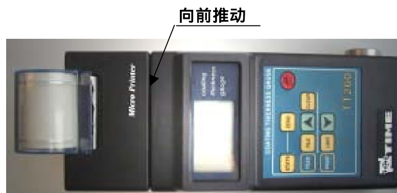
图 5-3 装、卸下打印头
