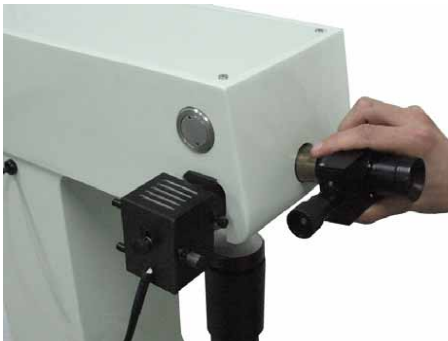
图 3.2-1 安装测量目镜
